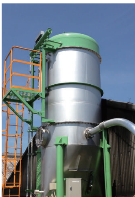
高真空 空気輸送用バグフィルター Bag filter for high-vacuum pneumatic conveyance
