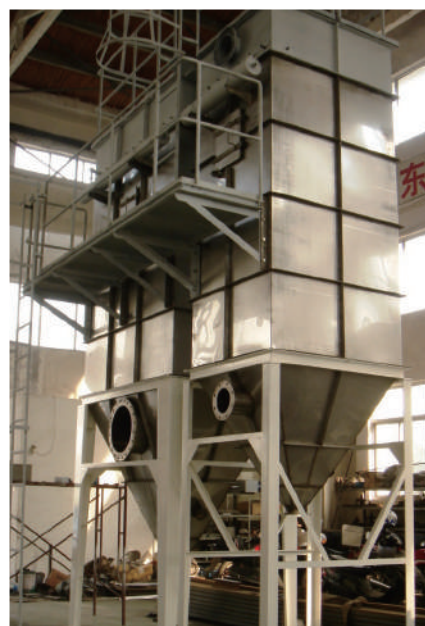
ステンレス製 大型集塵機 Large stainless-steel Dust collector
