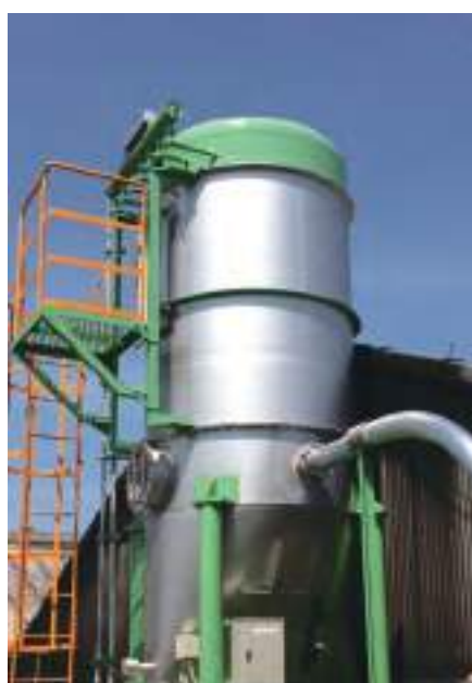
高真空 空気輸送用バグフィルター Bag filter for high-vacuum pneumatic conveyance
